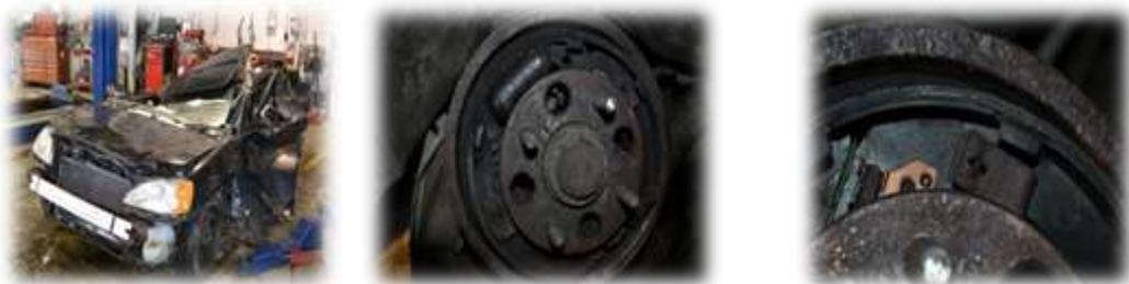
*(L'état de ce véhicule, une Honda Civic d'année modèle 2001, a contribué à un accident mortel en 2016. L'inspection post accident a démontré que la défaillance des pistons et la fuite d'huile à frein sur les garnitures sont des facteurs. Est-ce qu'une inspection avant aurait pu prévenir ou minimiser cet accident mortel? Personne ne le saura, mais peut-être...)*
