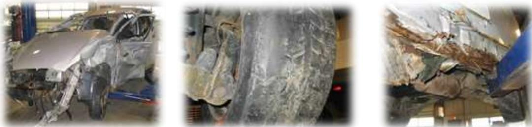
*(L'état de ce véhicule, une Ford Focus d'année modèle 2002, a contribué à un accident mortel en 2015. L'inspection post accident a démontré un frein corrodé, une structure très affaiblie par la corrosion et les pneus usés à la corde. Est-ce qu'une inspection aurait pu prévenir ou minimiser cet accident mortel? Personne ne le saura, mais peut-être...)*
